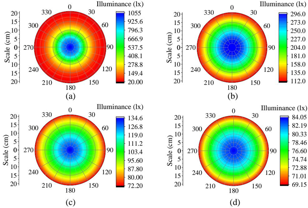
Fig. 4. Illuminance distributions at distances of (a) 5 m, (b) 10 m, (c) 15 m, and (d) 20 m.
